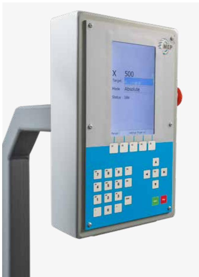
Controllo con display da 7" montato lateralmente al quadro comandi della segatrice e completo di funzione contapezzi, compensazione dello spessore lama e dispositivo per la programmazione da remoto tramite cavo ethernet.
